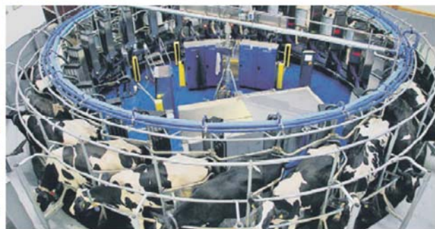
Merlin Fullwood: In der Agrar GmbH Flämingland Blönsdorf wurden zwölf Melkroboter im Halbkreis angeordnet. Die Kühe können die Automaten gruppenweise über einen Vorwarte Hof erreichen und kehren danach wieder in den Stall zurück.
