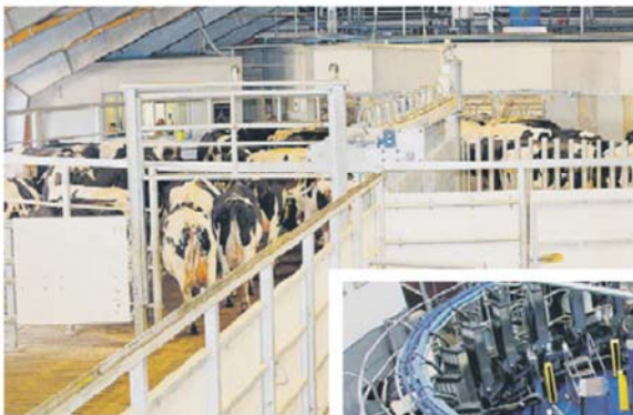
Merlin Fullwood: In der Agrar GmbH Flämingland Blönsdorf wurden zwölf Melkroboter im Halbkreis angeordnet. Die Kühe können die Automaten gruppenweise über einen Vorwarte Hof erreichen und kehren danach wieder in den Stall zurück.
